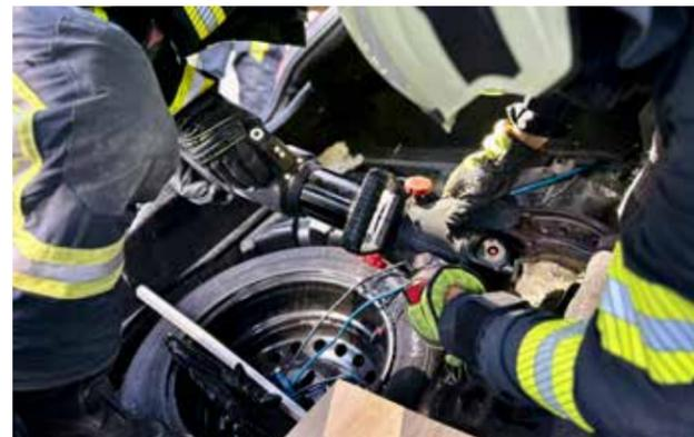
Am 13. Juni wurden zwei Übungen abgehalten. Im ersten Szenario wurde ein Verkehrsunfall mit einem Elektroauto, drei Dieselfahrzeugen und mehreren Verletzten simuliert. Nachdem die Fahrzeuge gesichert wurden, befreite man die Personen mittels hydraulischer Rettungsgeräte. Ebenfalls wurde der Emergency Plug für Elektroautos getestet.
